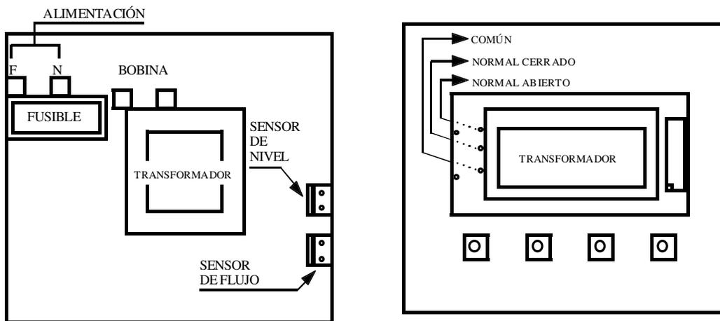
Este equipo posee un rango extendido de tensión de alimentación y mantiene el caudal que dosifica constante independientemente de que la línea varíe gracias a que electrónicamente se mantiene constante el valor medio de la corriente que alimenta el electroimán. Si la tensión de línea excede 260 Vac (o cae debajo de 150 Vac en el caso de baja tensión) el equipo detiene el electroimán, indica en pantalla el mensaje “Fuera de línea” y envía señal de alarma a través del relé de alarma.
