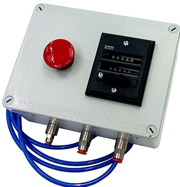
Sistema de dosificación neumático para todas las bombas neumáticas. Consiste en establecer el número de ciclos.
